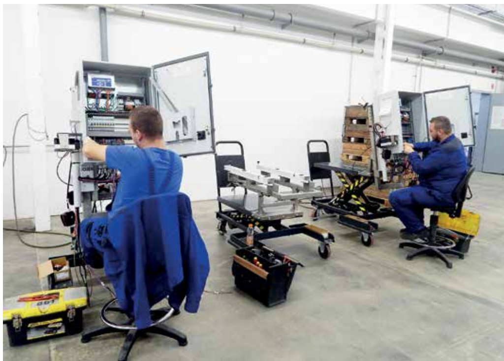
Az egyik fontos feladat az elektromos kapcsolószekrény előkészítése a Güntner-Tata Kft-nél
