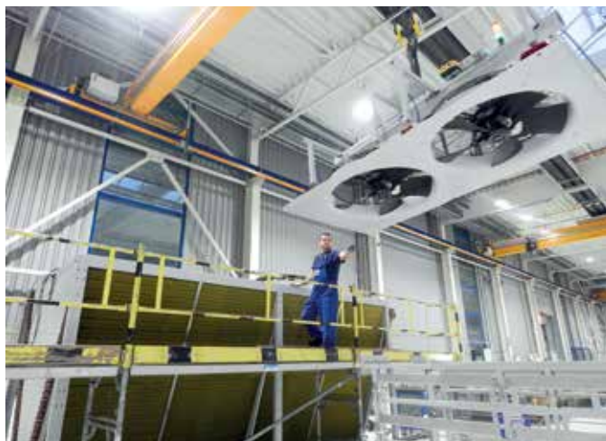
Így történik a Jumbo kondenzátor végszerelése
